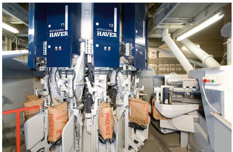
Eine Klassiker bei Haver & Boecker: Der HAVER ROTO-PACKER® füllt seit über 50 Jahren Schüttgüter ab.
